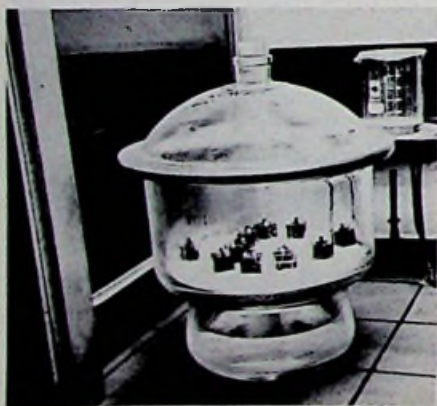
Bild 17. Rezipient, in dem Teile aggressiven Dämpfen ausgesetzt werden
